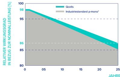
Mindestens 98% der Nennleistung innerhalb des ersten Jahres. Danach max. 0,5% Degradation pro Jahr. Mindestens 93,5% der Nennleistung nach 10 Jahren. Mindestens 86% der Nennleistung nach 25 Jahren.
